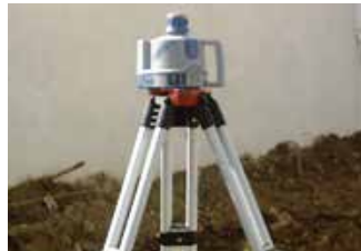
Vérification des niveaux à la lunette et terrassement de la fouille.
